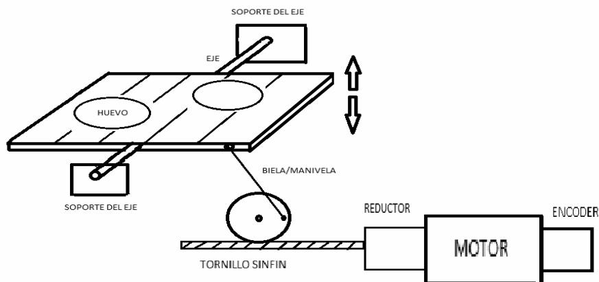
Describir cómo funciona dicho mecanismo. Proponer un sistema alternativo para el volteo de los huevos, explicando con un esquema su funcionamiento y los elementos que lo componen.
