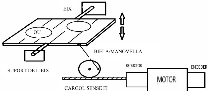
Descriuix com funciona aquest mecanisme. Proposeu un sistema alternatiu per al girament dels ous i expliqueu amb un esquema com funciona i els elements que el componen.
