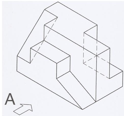
3. Dibuja en perspectiva isométrica y a la escala E= 3/2, la figura adjunta dada por las vistas diédricas. Toma las medidas directamente de las vistes.
